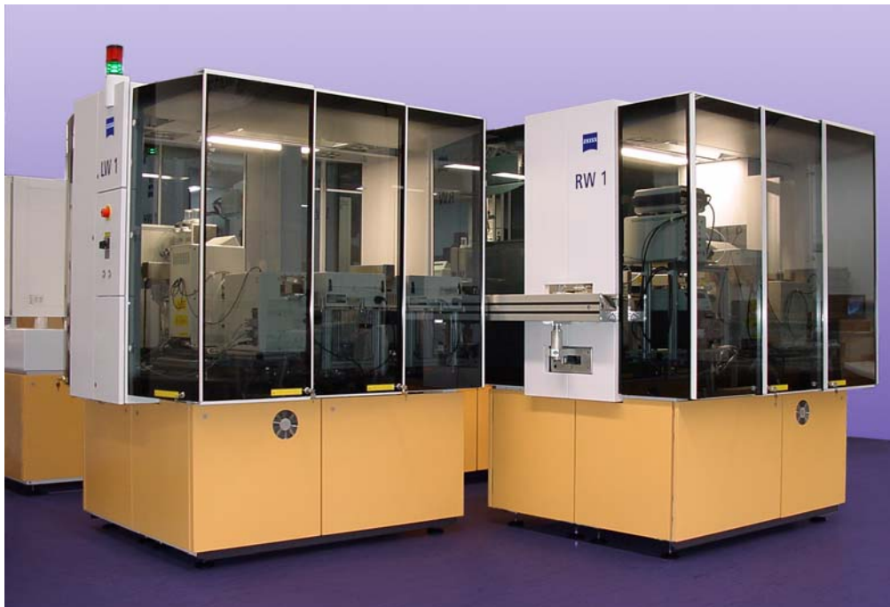
Abb. 14 Zeiss/ EvoTec uHTS System, zur vollautomatischen Durchführung eines ELISA-Tests
